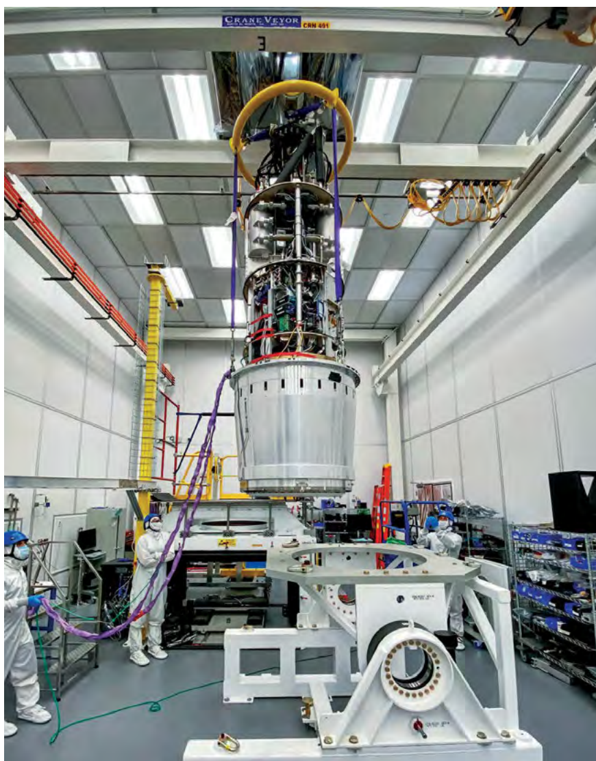
Insenerid seavad katsetamiseks valmis Tšiilis Cerro Pachóni mäele kerkiva teleskoobi LSST kaamerasüsteemi. See maailma suurim CCD-kaamera koosneb 201 andurist, tugielektronikast ning vaakum- ja jahutussüsteemist
