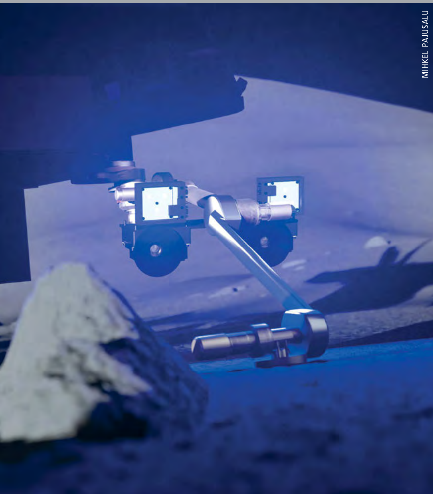
Illustratsioon Crystalspace'i Kuule minevatest kaameratest kulguri robotkäpa küljes koos valgusallikatega
